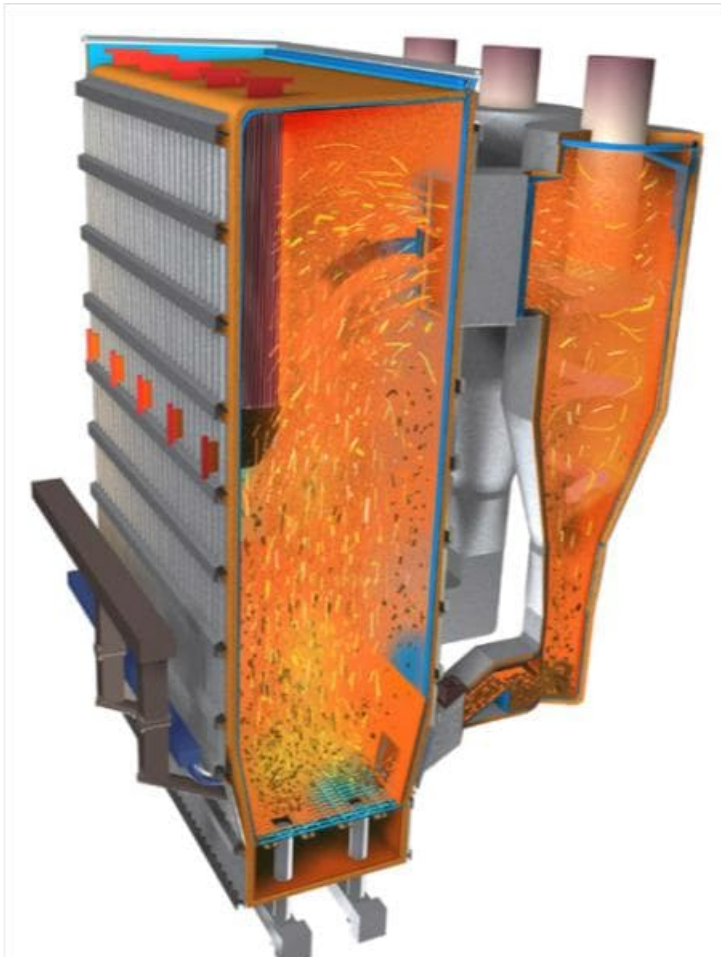
Figur 7. Illustration av en cirkulerande fluidbäddpanna.
