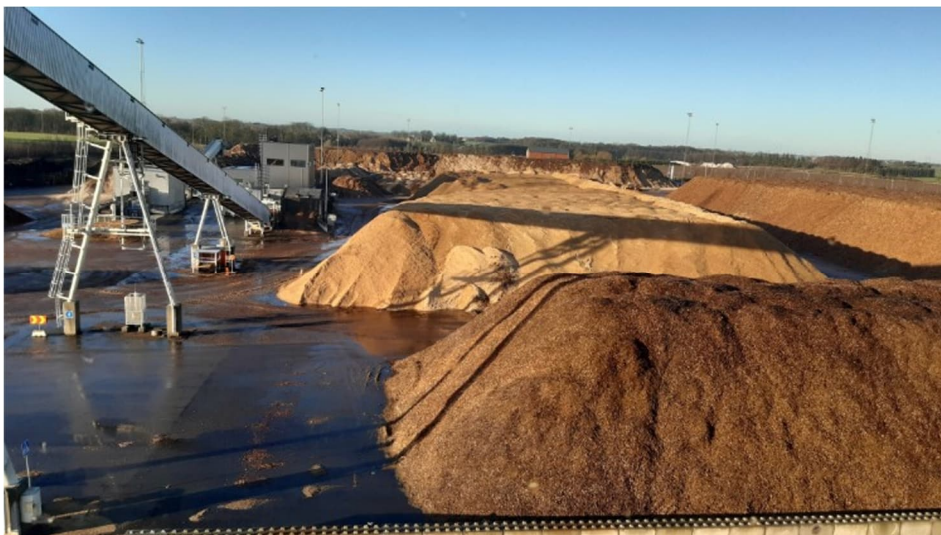
Figur 9. Bränslelagring vid befintlig verksamhet. På bilden syns lagerytan, sållhuset med skivsåll, bandmagneter och rejektkross samt transportbandet till pannan.
