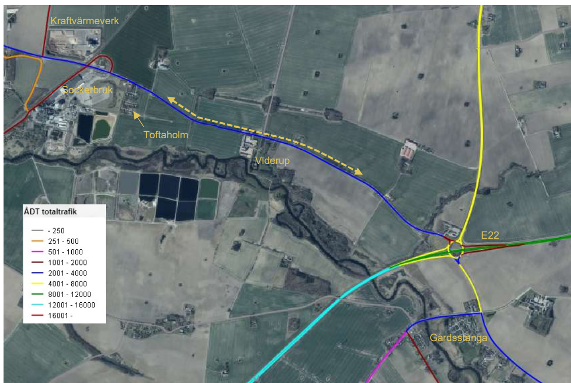
Figur 7. Väg 104 öster om kraftvärmeverket. Streckad gul pil visar sträcka med smalare vägsektion och kantad av trädallé. Kartunderlag: NVDB på webb (2022), bearbetad av Sweco.
