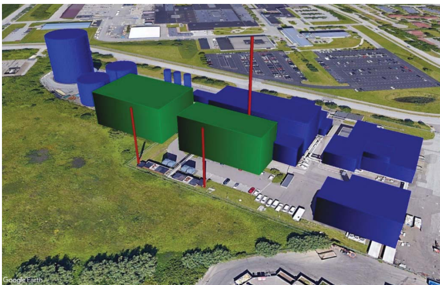
Figur 2. Befintliga byggnader som har betydelse för spridningsberäkningarna (blåfärgade) tillsammans tillkommande pannhus och byggnad för reningsanläggning (grönfärgade) med skorstenar (rödfärgade).
