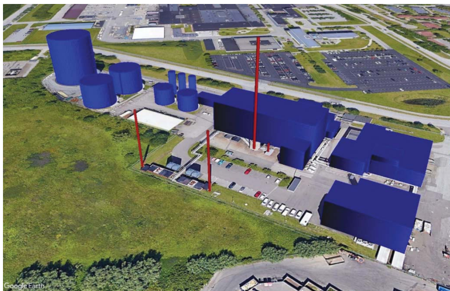
Figur 1. Befintliga byggnader som har betydelse för spridningsberäkningarna (blåfärgade) tillsammans med skorstenar (rödfärgade).
