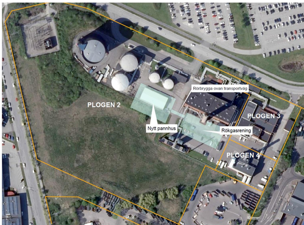
Figur 5. Förespråkad lokalisering av pannhus för ny panna/nya pannor samt placering för rökgasrening inom fastigheten Plogen 2.
